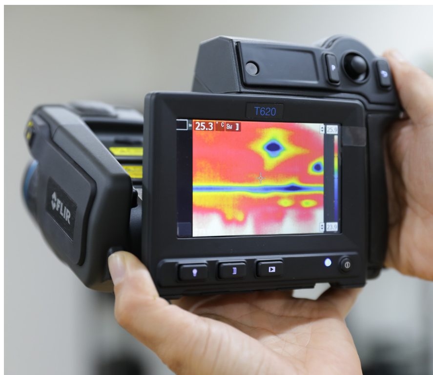
赤外線カメラでは外壁の浮きや漏水を確認(青い部分は漏水が疑われる箇所)
