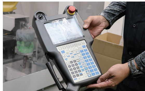
プログラムを入力するための制御盤
