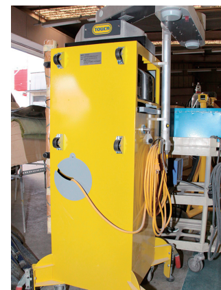
測定が難しい車底部分もタッチセンサーで測定できる「3次元計測機」
