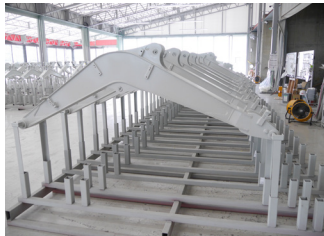
塗装を待つ大型の建設機械部品
