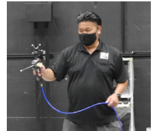
熟練作業者の動きを専用カメラでとらえデータ化
