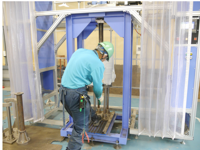
専用補助装置に洗濯槽をセット
