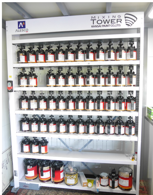
補修用塗料棚（カラーナビの指示によりボトルを選んで配合する）
