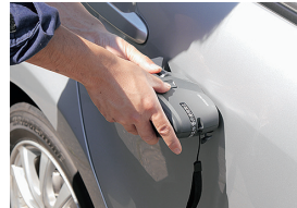
カメラでボディーカラーを測定
