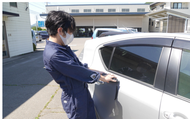
カメラでボディーカラーを測定
