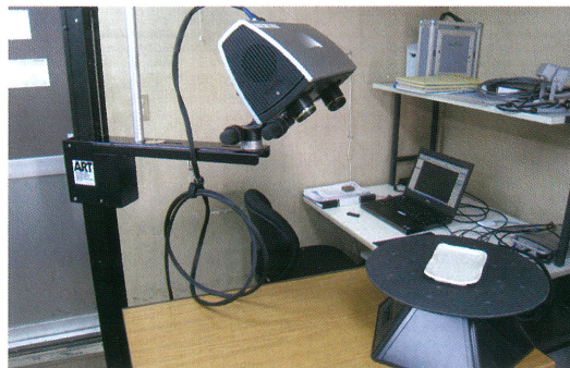
▲「COMET L3D」による3次元測定
