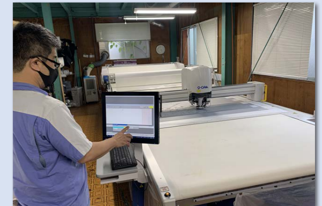
CADにより裁断工程が自動化され作業時間が大幅に削減
