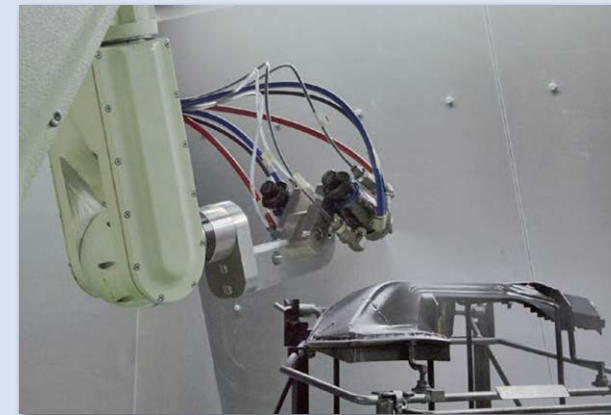
導入したロボット塗装機により生産性が向上
