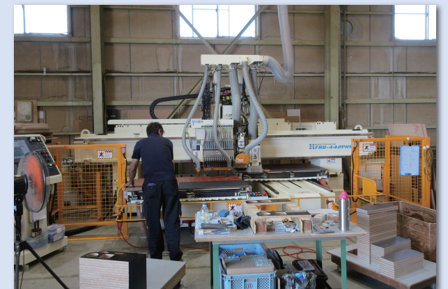
導入した複合ボーリングマシン
