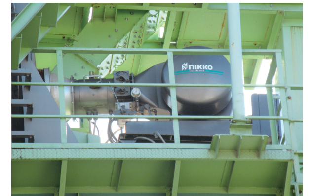
導入された骨材ドライヤー
