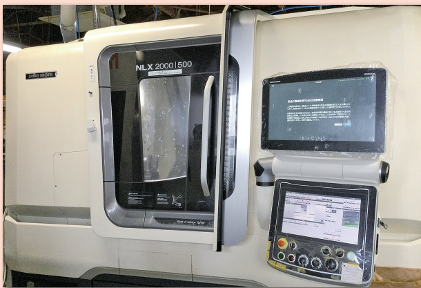
導入した切削油の温度管理機能付きNC旋盤
