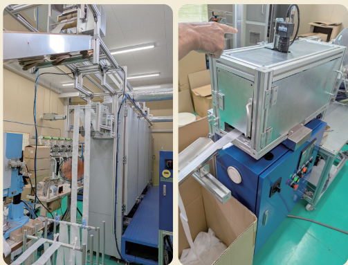
「左：細幅織物熱セット加工機」と 「右：傷探知機能付きテープ巻取機（自動巻取機）」
