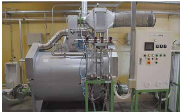
洗浄した羽毛を乾燥と同時に熱消毒する乾燥機
