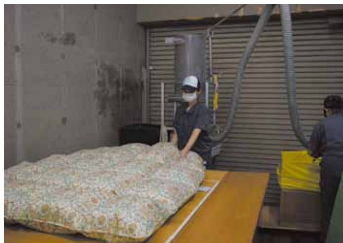
洗浄、乾燥した羽毛の吹き込み作業
