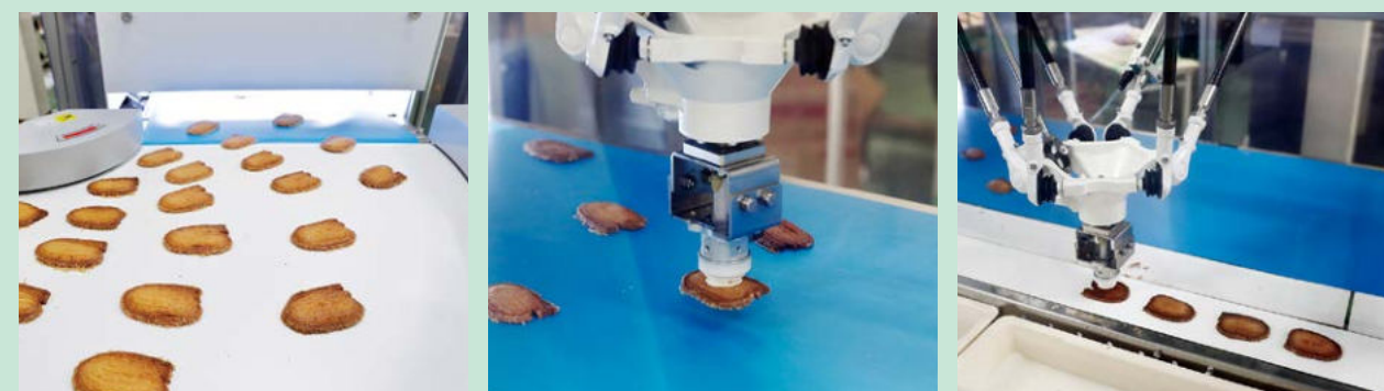
①焼成されたパイを画像判定機能で検品します ②良品のみをロボットアームが持ち上げます ③持ち上げた良品を包装ラインに移動します
