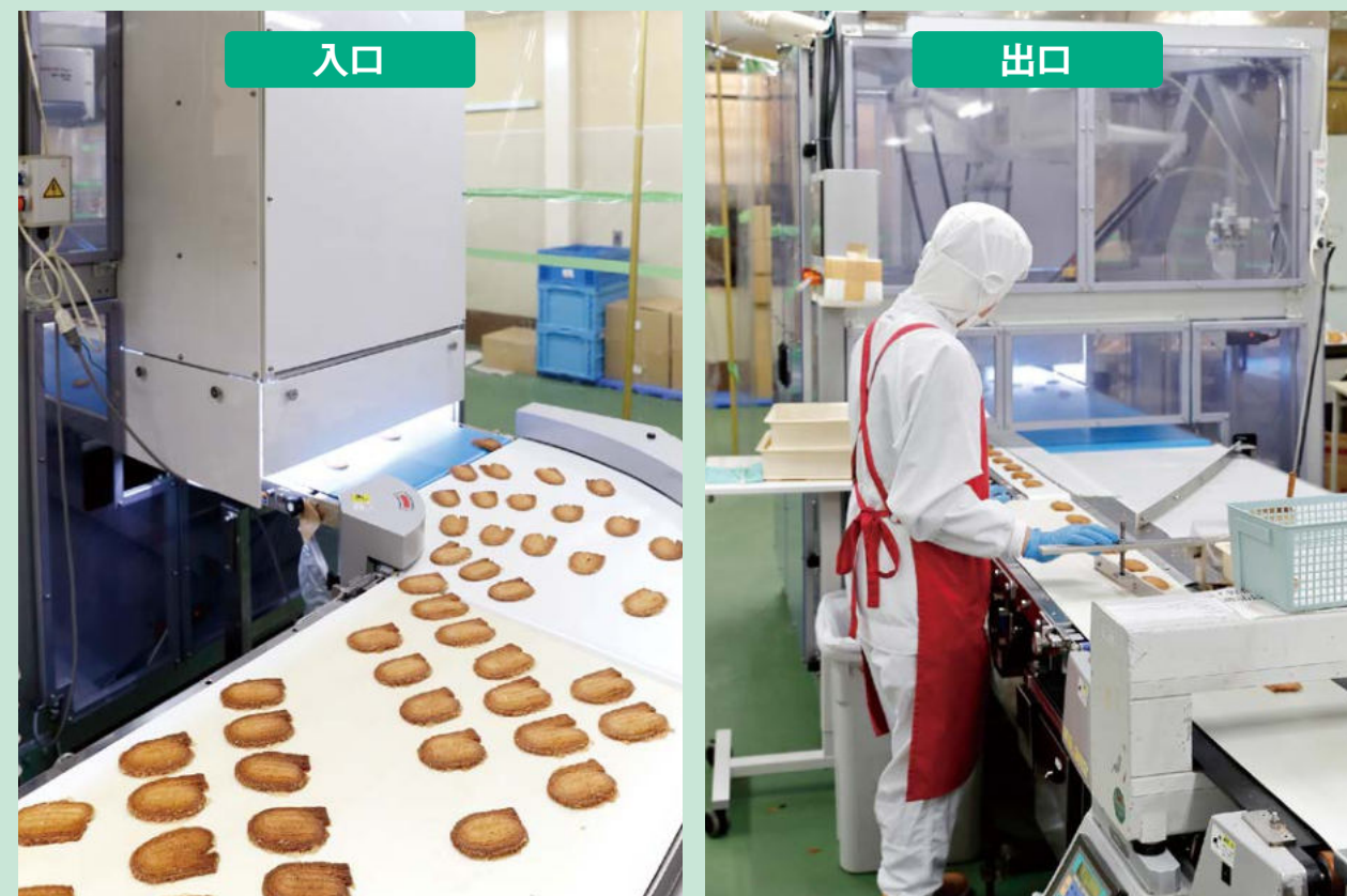
画像判定による検品と包装ラインへの自動供給を行います
