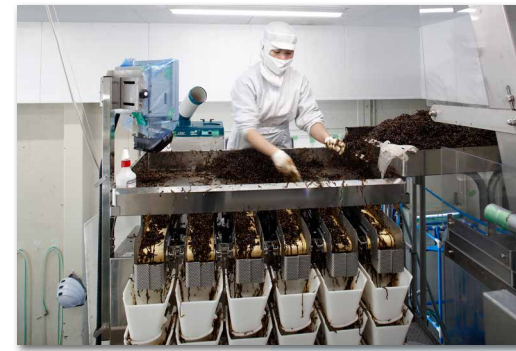
【自動重量はかり】昆布を自動重量はかりへ供給
