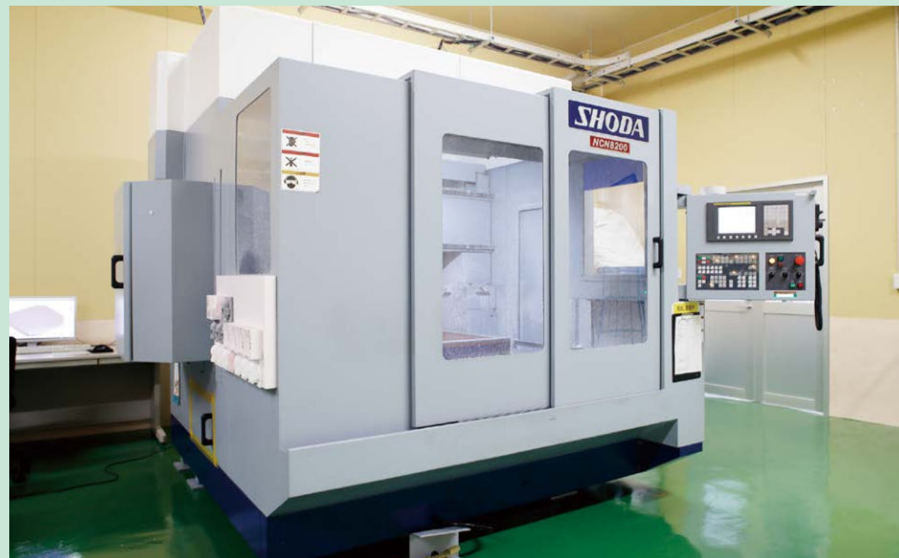
小型精密NCルータマシンNCN8200： X軸Y軸Z軸を制御することによる切削設備
