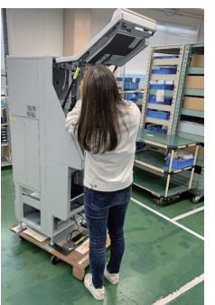
券売機組み立て作業
