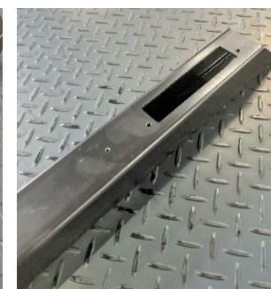
一貫工程を経た製品 切削、穴あけ、切りかけの高度な要求水準を満たしている
