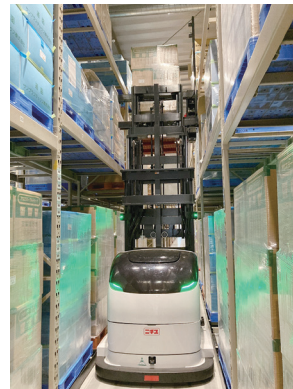
無人搬送機が狭いラック間で荷物を収納している様子
