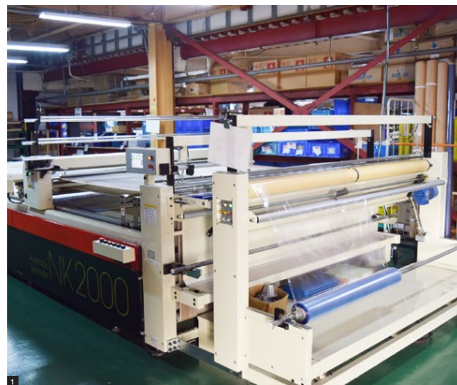
1 導入した高速定寸カットシステム
