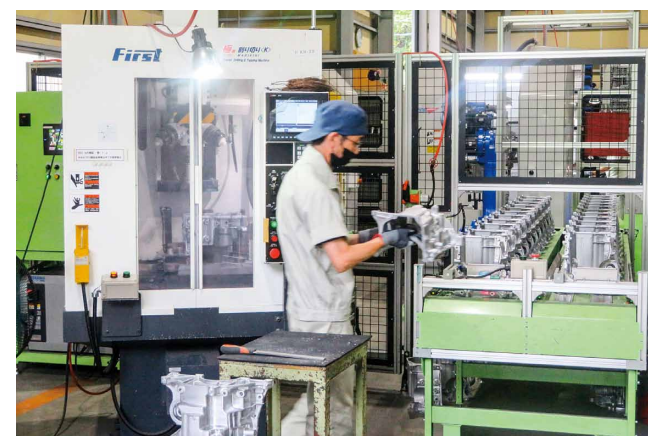
自動バリ取り機（左）を導入し、人手による作業から置き換えた
