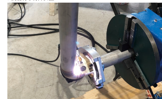
▲外からの熱で裏側も溶かし込む裏波溶接は、超純度配管には必須の技術だ
