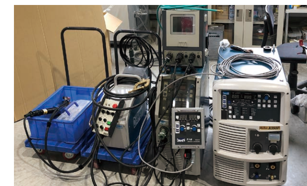
▲極薄板から厚板まで溶接可能なTIG溶接機と溶接条件作成アシスト機能付き制御装置
