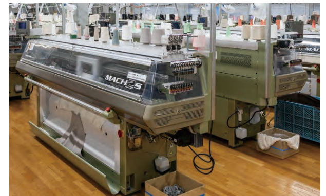
▲需要の多い10ゲージ対応の無縫製横編み機
