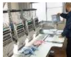
今回導入したタジマ多頭式 電子刺繍機(TMCR-V1506F)
