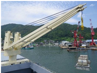
ツインデッキクレーン
