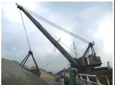
バケットクレーン
