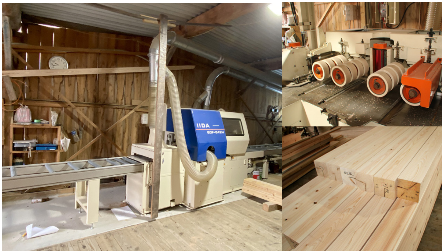
上下左右の四方向すべての側面を1回の加工作業で切削できる四面自動 かな 鉋盤のおかげで劇的に作業効率は向上した
