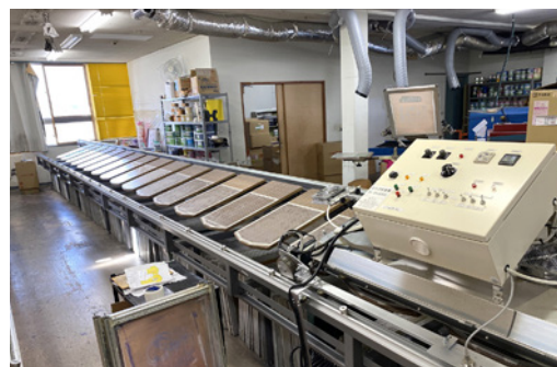
捺染印刷用の並行式印刷台と走行式乾燥機
