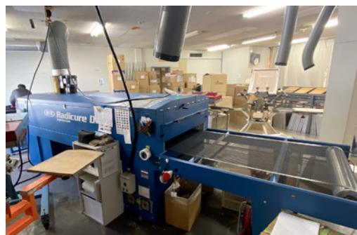
Tシャツ等の綿素材の衣料品に適した大型乾燥機
