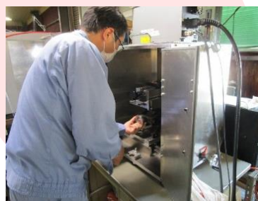
自社製作した刻印専用架台で 対象物の位置合わせをしている様子
