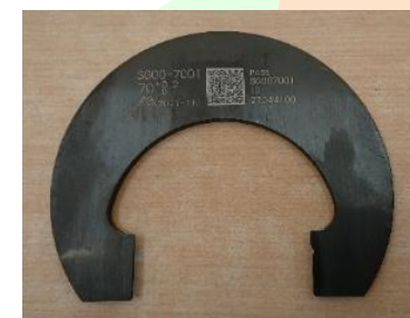
導入設備で QRコードを刻印したゲージ
