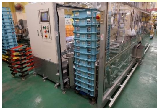
コンテナを台車に下ろす
