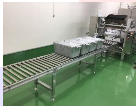
ガス半自動炊飯システム
