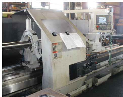
導入した旋盤加工設備によって 3,000ミリ以上の長尺シャフトにも対応
