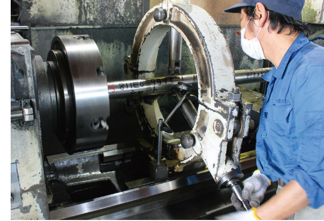
手作業で振れを調整する工程
