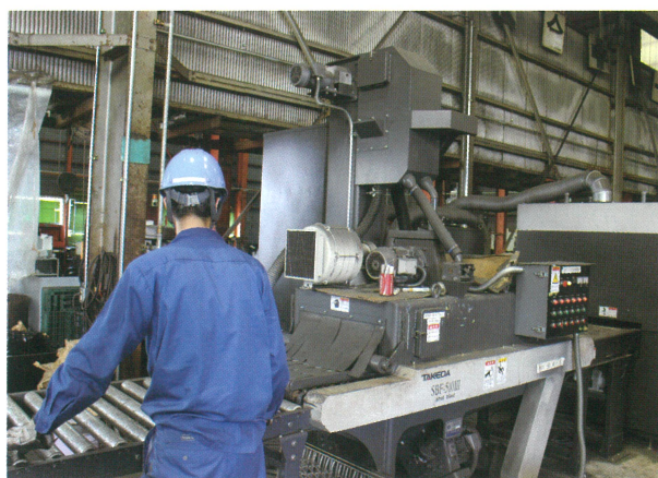
▲プレシェーバー（バリ取り機）とショットブラスト機をライン化
