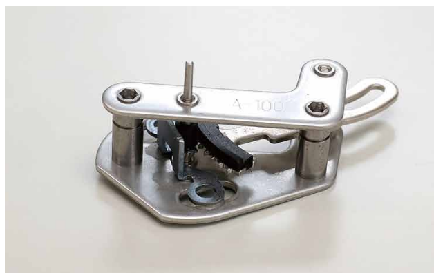
従来の機械式歯車に代えてマグネットギアを採用
