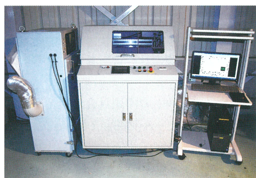
開発した鑄鉄黒鉛球状化率測定装置
