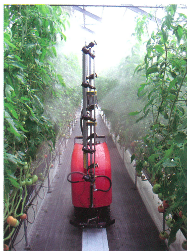
防草シート上を走行する農薬散布ロボット
