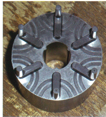
ボンド磁石を射出成型した試作ロータ
