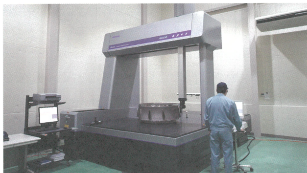
【図 1】三次元測定機の設置状態
