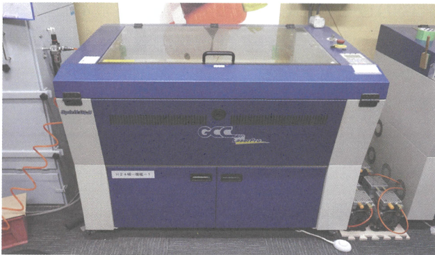
【図2】レーザー加工機の設置
