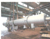
左から インナーボア型熱交換器（ハイカーボンステンレス） 攪拌槽（ジャケット付） 高圧熱交換器（低合金鋼／液圧拡張）
