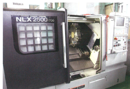
対向単動型油圧四爪チャック搭載NC旋盤機
