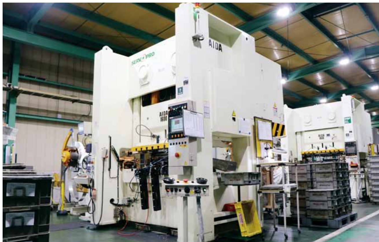
より複雑な加工が可能になった160トンサーボプレス機
