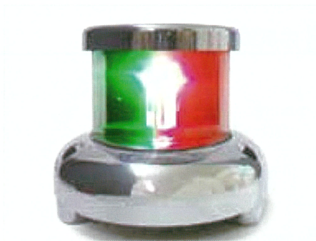
設置した LED 法定船灯
