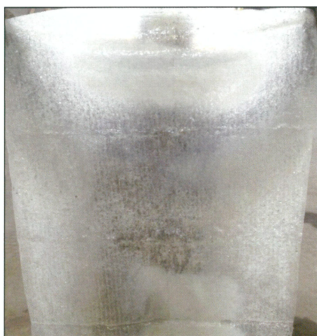
剥離機によりガラス片が完全に剥離されたPVB膜
