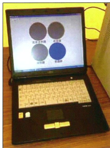
ラマン識別装置によるPVB膜の種類判定表示
