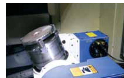
材料を斜めにセットしての切削が可能に
