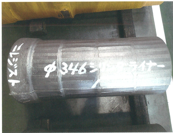
高 Ni-Cr 鋳鉄材コンプレッサライナ試作品の鋳込み時の状況および素材写真
