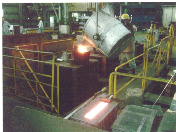
高 Ni-Cr 鋳鉄材コンプレッサライナ試作品の鋳込み時の状況および素材写真
