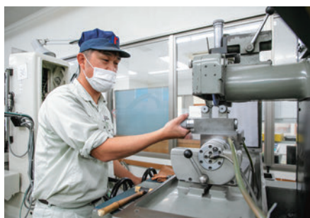
金属を削る砥石を成形。 これを従来は手で加工していた
