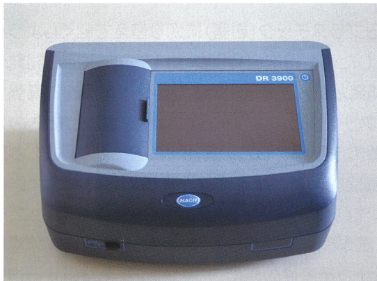
▲今回導入した吸光光度計。土壌から溶出した水溶液中の重金属濃度を測定する際や所定濃度の溶液調整時に使用し、公定法と現状の確認方法に相関性があるかを確認した
