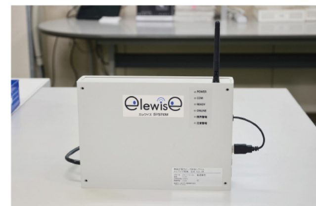
▲開発した無線式電力ピーク制御システムを「エレワイズ」として商品化。写真は親機
