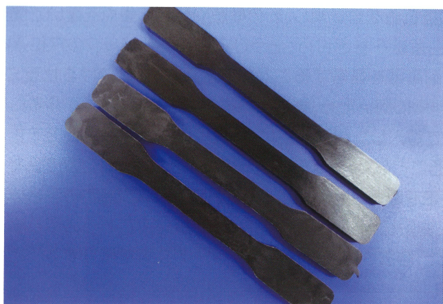
▲樹脂にカーボンフィラーを混練した射出成形品
