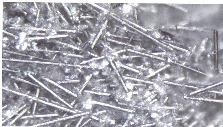
▲今回開発した高濃度カーボン繊維強化プラスチックの顕微鏡画像
